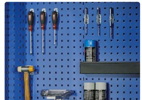
Die Rückwand besitzt eine 4-kant-Lochung 10 × 10 mm und Teilung 38 mm sowie vertikale Schlitz zum Einhängen von Zubehör.
