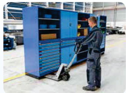
Schritt 3 Platzieren der Module mittels integriertem Hubwagensockel
